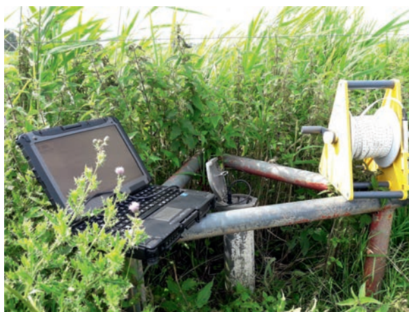
Grundwassermessstelle mit Datenlogger. Die Daten werden für die Modellierung des zukünftigen Wasserhaushalts in Küstenregionen genutzt.
